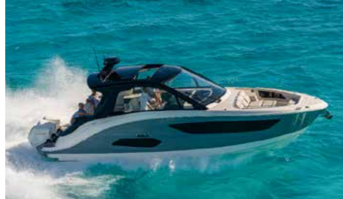
Dakontwerp voor extra grote panelen van glas en composiet
